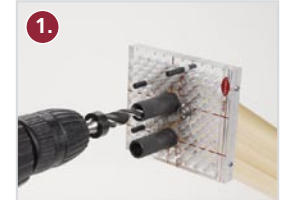
1. Mit 3 Bolzen Kontur abstecken und Löcher bohren
